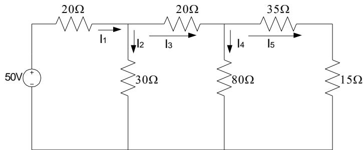
7. Por el método de voltajes de nodo encontrar todas las potencias disipadas por cada resistencia y comparar con la potencia que esta entregando la fuente de 240[V].
