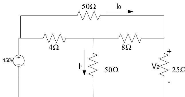
8. Hallar los valores de  $V_{R1}$ ,  $V_{R3}$ ,  $V_{R4}$ , por el método de divisor de voltaje y divisor de corrientes.
